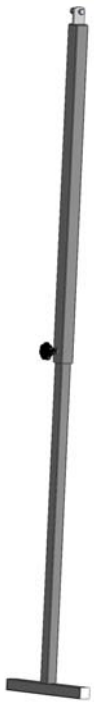
Фигура 3.5. Изглед на подпората на горивоподаващия шнек на горелката от серията “GP”;
