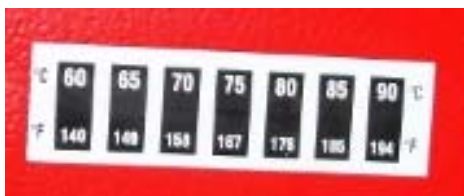
Фигура 5.2. Поглед към реверсивния (самовъзстановяващ се) термостикер за определяне на работната температура в зоната на горелката, в която е монтиран – състояние при стайна температура.
