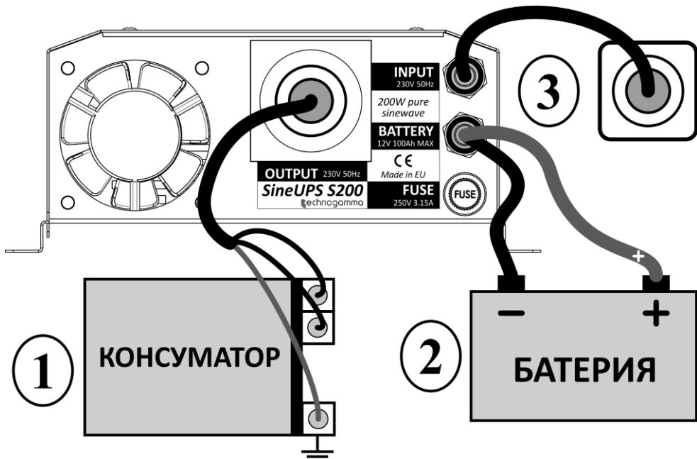
1. Свържете консуматора към кабелите от извод *OUTPUT*. Захранващите кабели (кафяв и син) се свързват към консуматора, а зануляващия проводник (жълто-зелен) се свързва само в случай, че консуматорът има специален занулителен извод.
