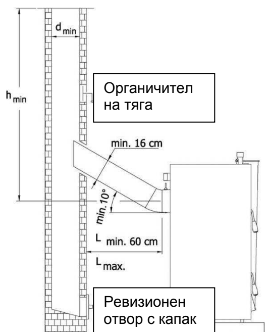
Фигура 12. Препоръчителни размери на комината система
