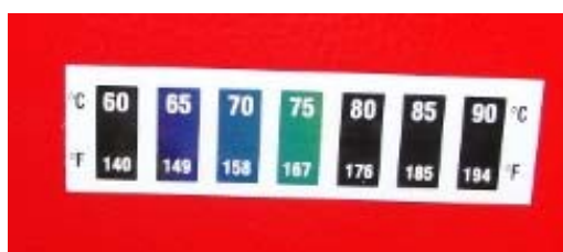
Фигура 5.4. Поглед към реверсивния (самовъзстановяващ се) термостикер за определяне на работната температура в зоната на горелката, в която е монтиран – състояние при повишена температура – в диапазона 70 – 75°C.
