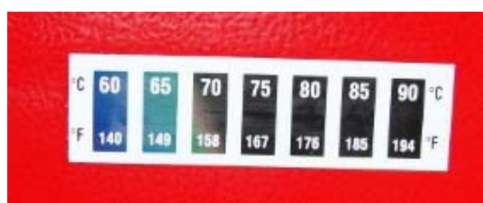
Фигура 5.3. Поглед към реверсивния (самовъзстановяващ се) термостикер за определяне на работната температура в зоната на горелката, в която е монтиран – състояние при повишена температура – в диапазона 60 – 65°C.
