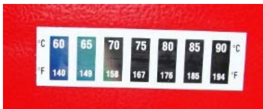
Фигура 5.5. Поглед към реверсивния (самовъзстановяващ се) термостикер за определяне на работната температура в зоната на горелката, в която е монтиран – състояние при повишена температура – в диапазона 60 – 65°C .
