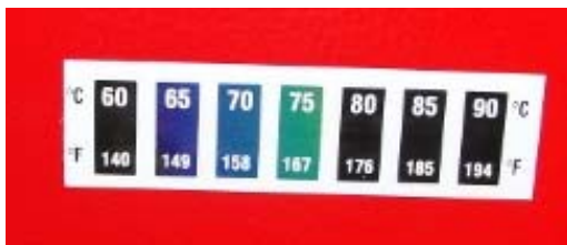
Фигура 5.5. Поглед към реверсивния (самовъзстановяващ се) термостикер за определяне на работната температура в зоната на горелката, в която е монтиран – състояние при повишена температура – в диапазона 60 – 65°C .
