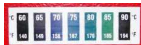
Реверсивния термостикер на горелката трябва да се проверява при всяко обслужване на съоръжението. Той показва необходимостта от почистване.
