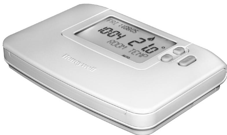
Термостат **CM907** е предназначен за осигуряване на автоматичен контрол и регулиране на време и температура при системи за отопление и охлаждане във вили и апартаменти. Той може да се използва като част от система в съчетание с комбинирани, нафтови котли с газово запалване, циркулационни помпи, термозадвижки, зоновенти и електронагревателни системи (<8А).
