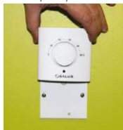
3. След като радиочестотното (RF) свързване е завършено (страница 7) плъзнете термостата върху задния панел, като се уверите, че двете страни са правилно позиционирани. Трябва да чуете типичното щракване, когато монтажът е коректен.
