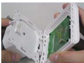
2. Сваляне на горния капак на пластмасовия корпус
