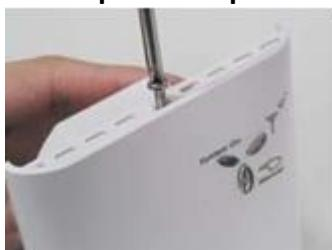
1. Разхлабете винта отгоре на пластмасовия корпус
