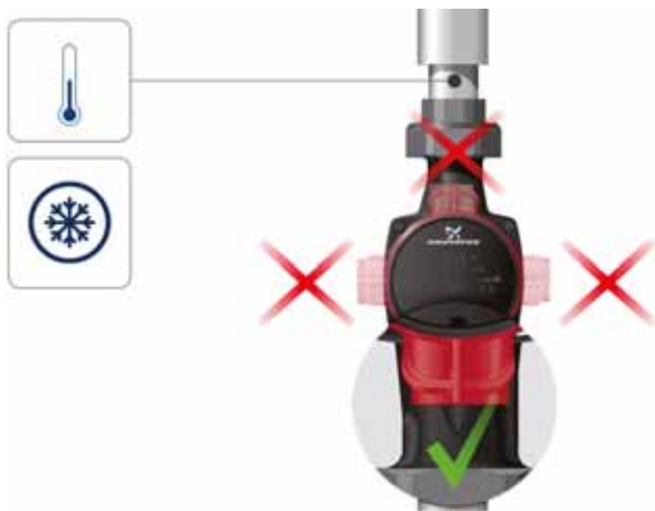
Фиг. 4 Разположение на блока за управление, климатични системи и системи за студена вода
