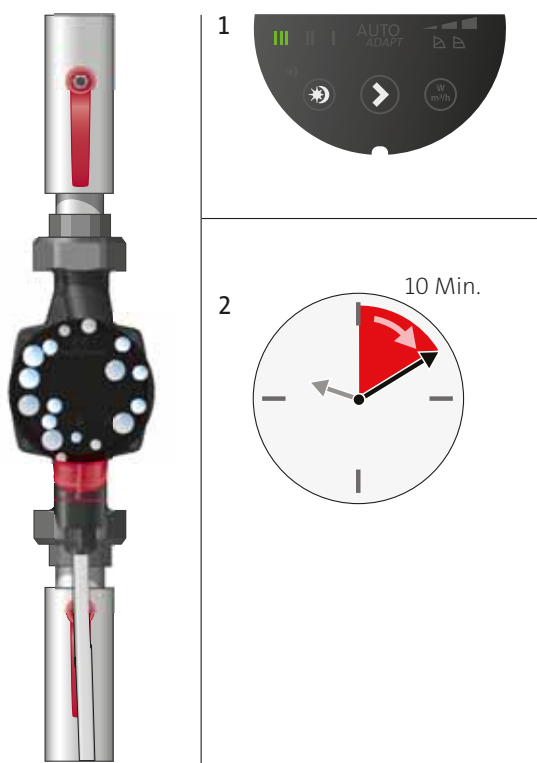
Фиг. 13 Обезвъздушаване на помпата
