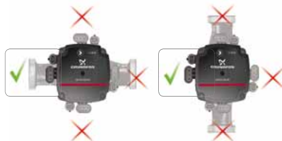
Фиг. 6 Положения на блока за управление, ALPHA SOLAR
