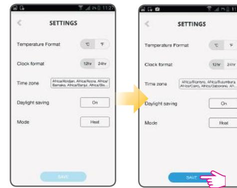
Изберете формат на температурата и часовника. Изберете Вашата часова зона, настройка за зимно/лятно време и режимът (отопление или охлаждане). Часът и датата автоматично ще се настроят, според часова зона, която трябва да настроите ръчно. Режим отопление (Heat) се използва за управление на котел. Режим охлаждане (Cool) се използва за управление на охлаждащо устройство.
