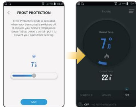
Може да включите или изключите Режим Frost от устройството чрез натискане на бутона еднократно. Погледнете инструкциите по-долу.
