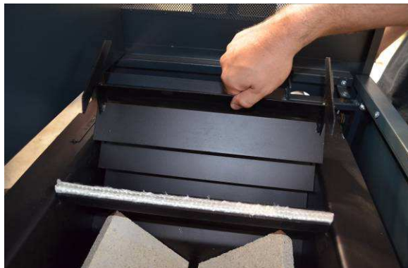
Фигура 5.7. Монтаж на турбулизаторите на двата хода на топлообменника.
