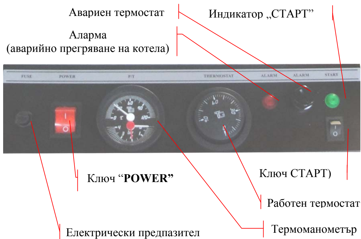
Фигура 5.1. Интерфейсно табло с контролни и управляващи уреди на водогрееен пелетен котел от серията “Pelletherm v4”.
