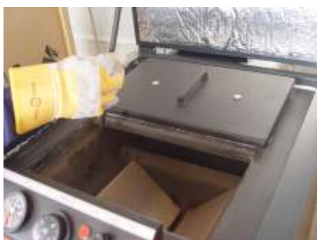
Почистете с изстъргване стените на теплообменника.
