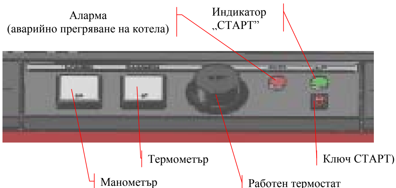
Фигура 5.2. Интерфейсно табло с контролни и управляващи уреди на водогрееен пелетен котел от серията “Pelletherm 18 v4”.
