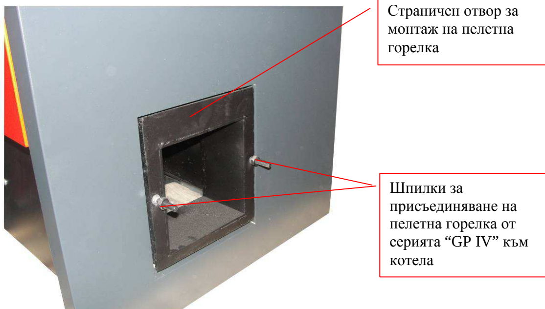
Фигура 4.2. Изглед към фланеца за присъединяване на автоматизираната пелетна горелка към котела ( показан е вариант с десен монтаж на пелетната горелка );
