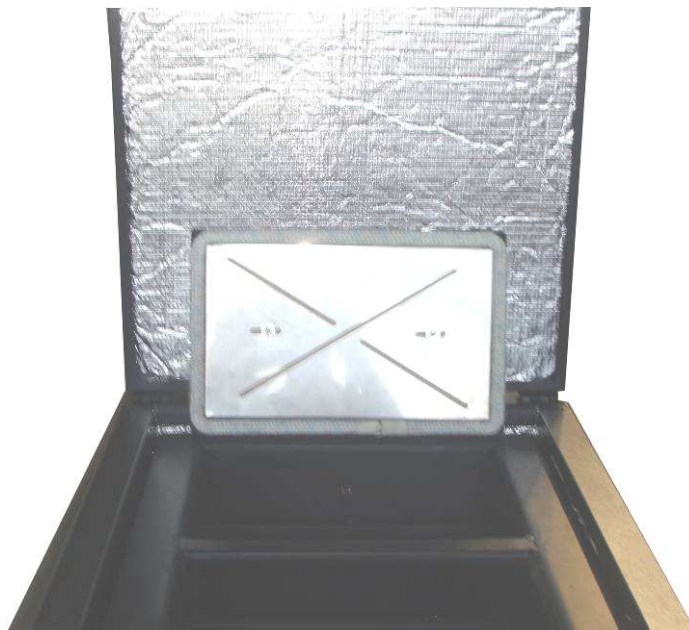
Фигура 4.9. Направляващ капак над конвективния тракт на котела;
