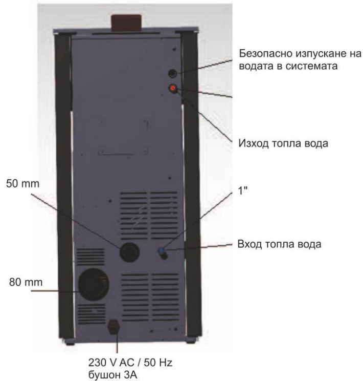
Фигура 3.11. Свързване на хидравличната система на камината.
